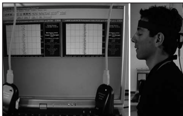
Fig. 1: Sono rappresentati i due rilevatori delle accelerazioni del capo e del tronco che costituiscono il sistema Delos DPE, collegati a PC portatile. A destra è mostrato il posizionamento dei rilevatori rispettivamente sullo sterno e sulla nuca. Durante il cammino l'apparecchiatura registra le oscillazioni dei segmenti in senso antero-posteriore (Y) o latero-laterale (X)
